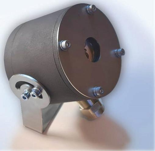
**АСВП-ЛВ.МФУ** работает в ждущем режиме. При срабатывании происходит динамичное выбрасывание в пространство горной выработки огнетушащего материала энергией сжатого воздуха (газа), находящегося под высоким давлением в системе. В результате в объеме горной выработки по всему её сечению на пути распространения фронта пламени формируется надежный заслон в виде долгоживущего облака огнетушащего материала во взвешенном состоянии.
